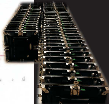
Handliche Alu-Druckguß-Gehäuse für verschiedenste Pixelabstände. In unterschiedlichen Größen für den raschen Auf- und Abbau.
